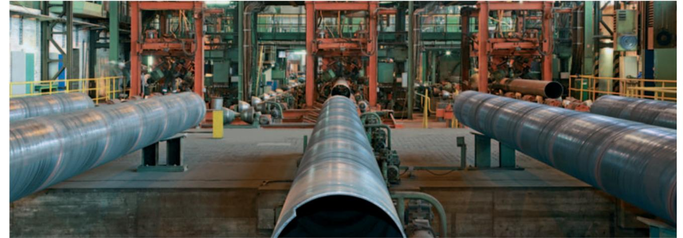
Rechnergesteuerte UP-Innen- und -Außenschweißstände
